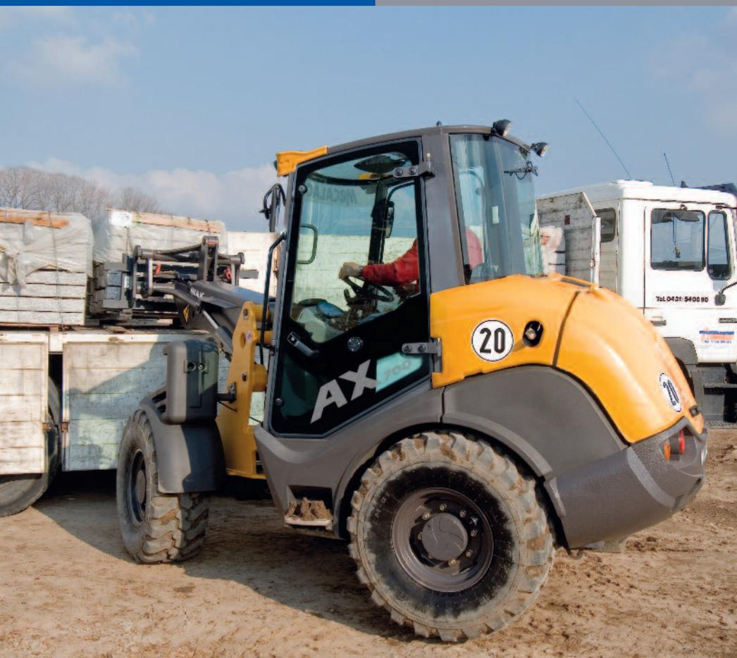
**Le bras mono-boom** de l'AX apporte une force d'arrachement élevée. La cinématique en Z permet un levage parallèle performant et le chargement de palettes en toute sécurité. Des cycles de travail courts et une excellente visibilité sur les accessoires rendent le travail plus productif.
